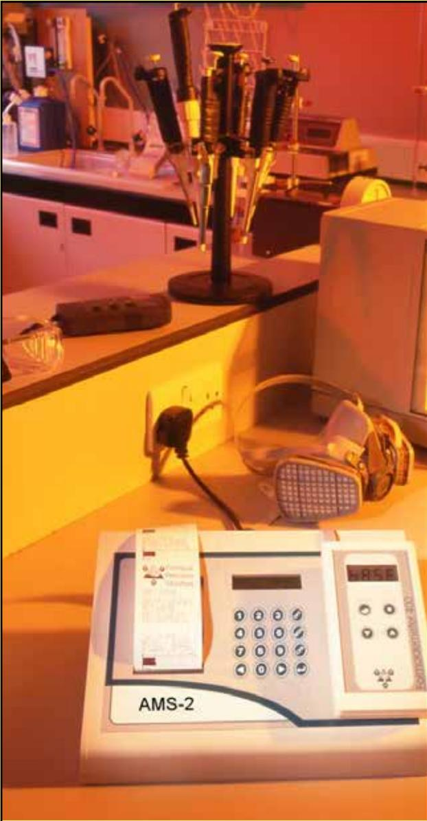
AMS-2 ist ein kompaktes Tischgerät das mit dem Formaldemeter 400 und Glutaraldemeter 3 kontinuierliche Messung von Formaldehyd- und Glutaraldehydkonzentrationen ermöglicht. Durch die Kombination mit AMS-2 werden die Geräte zu kontinuierlichen Datenloggern mit Anwender-konfigurierbarem akustischem Alarm.
